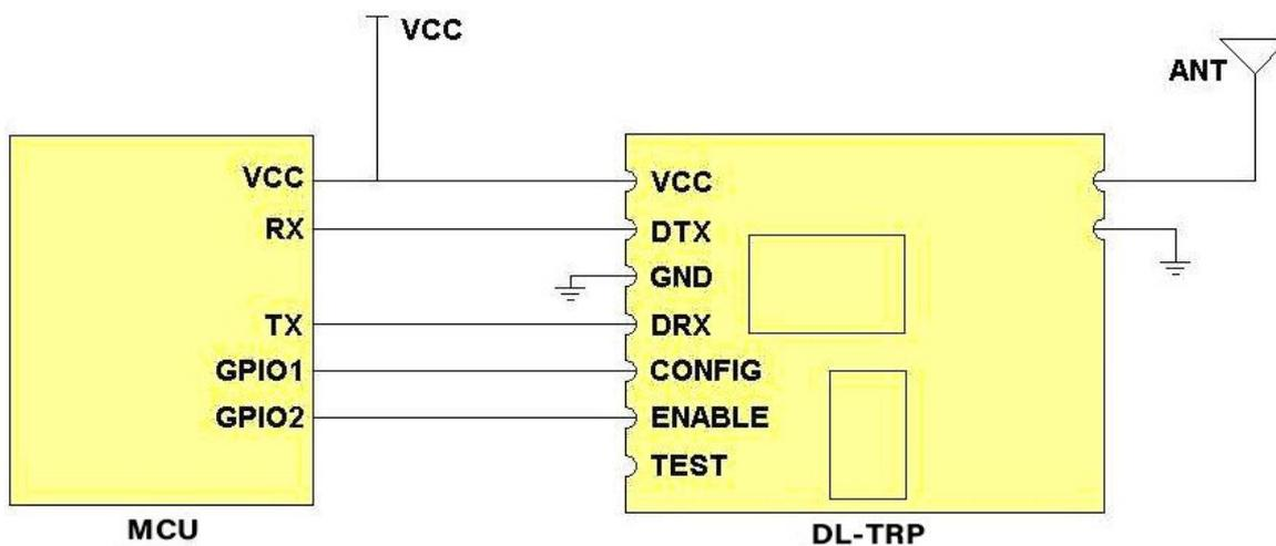
图 3: DL-TRP TTL 电平 UART 串行接口应用
